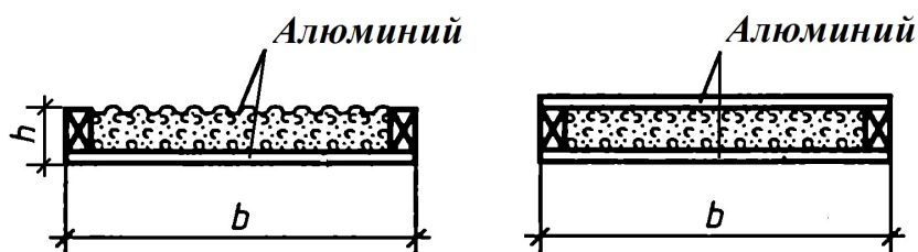
7.3-расм. Уч қатламли пластмасса ёпмаларнинг кўндаланг кесими.
