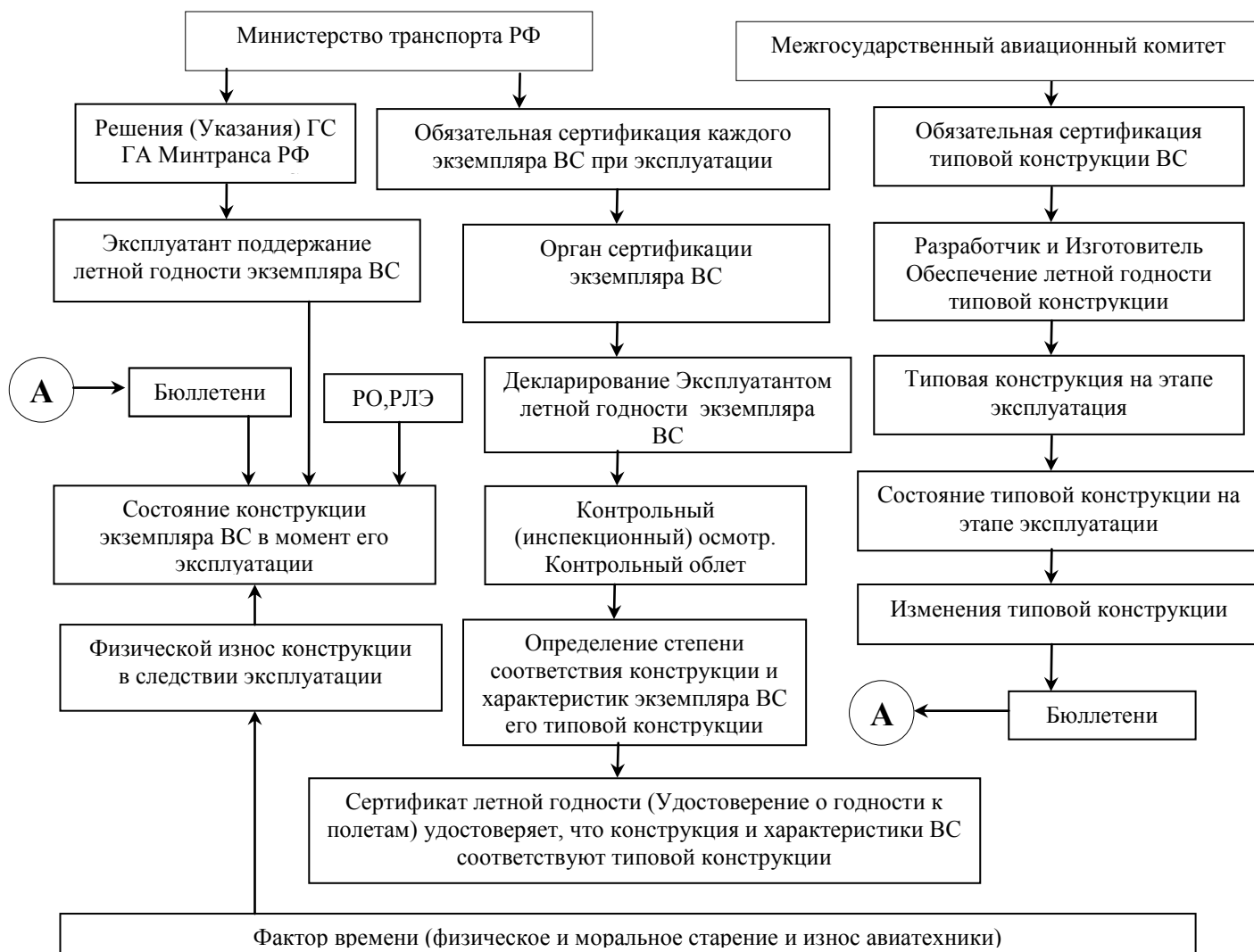
Рис. 3. Государственный контроль за летной годностью гражданских воздушных судов на этапах разработки, производства и эксплуатации (РО – Руководство по техническому обслуживанию; РЛЭ – Руководство по летной эксплуатации)
