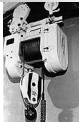
7.3-rasm. Avtomobil agregatlarini yechib olish-o'rnatish jihozlari
