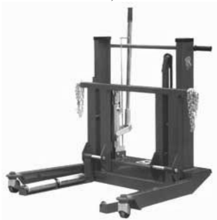
7.5-rasm. Avtomobillar 'gildiraklarini yechib olish, o'rnatish va eltish uchun aravacha. a- umumiy ko'rinishi; b- ish jarayonida.
