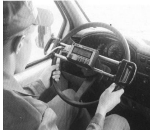
5.3-rasm. Rul boshqarmasining umumiy lyuftni ISL-M jihozida aniqlash
