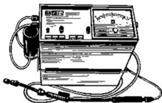
3.3-rasm. GAI-1 va Avtotest gazoanalizatorlarining umumiy ko'rinishi
