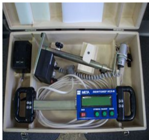
5.2-rasm-Rul boshqarmasining umumiy lyuftni aniqlash uchun ISL-M jihozi.
