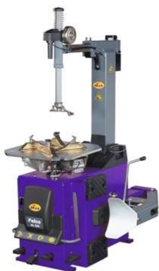
8.6-rasm. Yengil avtomobil shinasini ajratish-yi'gish jihozi, mod.AL 520, AL 520 IT va uni joylashtirish
