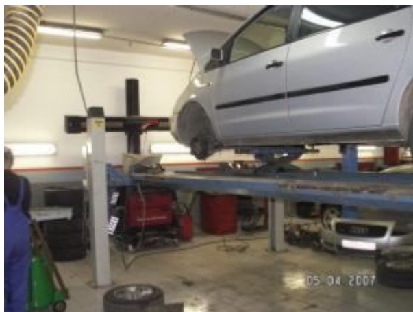
8-rasm. Boshqariluvchi g'ildiraklarni o'rnatilish burchaklarini sozlash posti
