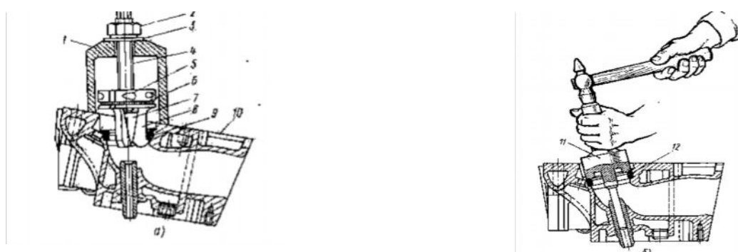
12-rasm. Klapan egarini almashtirish shakli: a-echgich yordamida egarni yechish; b-egarni qoqish; 1-echgich korpusi; 2-gayka; 3-shayba; 4-vint; 5-uch ushlagichli gayka; 6-tortish prujinasi; 7-ushlagich konusi; 8-echgich ushlagichi; 9, 12-o'rnatilgan egarlar; 10-tsilindrlar kallagi; 11-qoqqich
