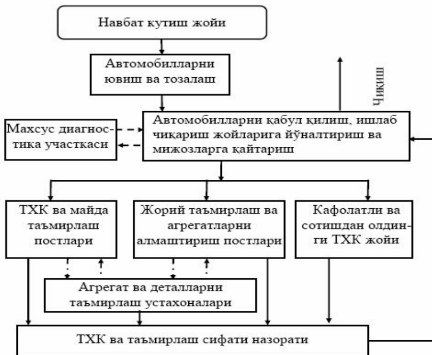
4.1-расм. АСКларда автосервисни ташкил қилишнинг технологик жараёни. —→ - автомобиллар ҳаракатининг асосий йўналиши; - - -→ - автомобиллар ҳаракатининг баъзи қоллардаги йўналиши; ····→ - таъмирланадиган агрегатлар ва деталлар йўналиши;
