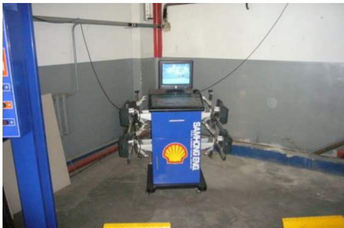
8-rasm. Boshqariluvchi g'ildiraklarni o'rnatilish burchaklarini sozlash posti
